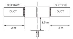
※ Measuring place : Anechoic chamber
